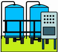
**Planta de tratamiento de agua potable (PTAP):** Se ampliará la capacidad de tratamiento de **7 a 10 lps** mediante la intervención completa de las unidades de coagulación, floculación, sedimentación, filtración y desinfección, incluyendo renovación de equipos de dosificación, bombeo y manejo de lodos, permitiendo operar de forma continua las 24 horas.
