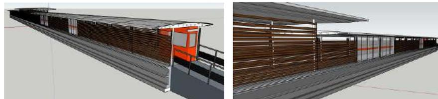
Se propone una intervención estructural sobre el puente peatonal central, mediante la construcción de una cubierta arquitectónica que unificará ambos costados, dando lugar a una estación corrida más funcional, con mejores condiciones de sombra, ventilación y circulación para los usuarios.
