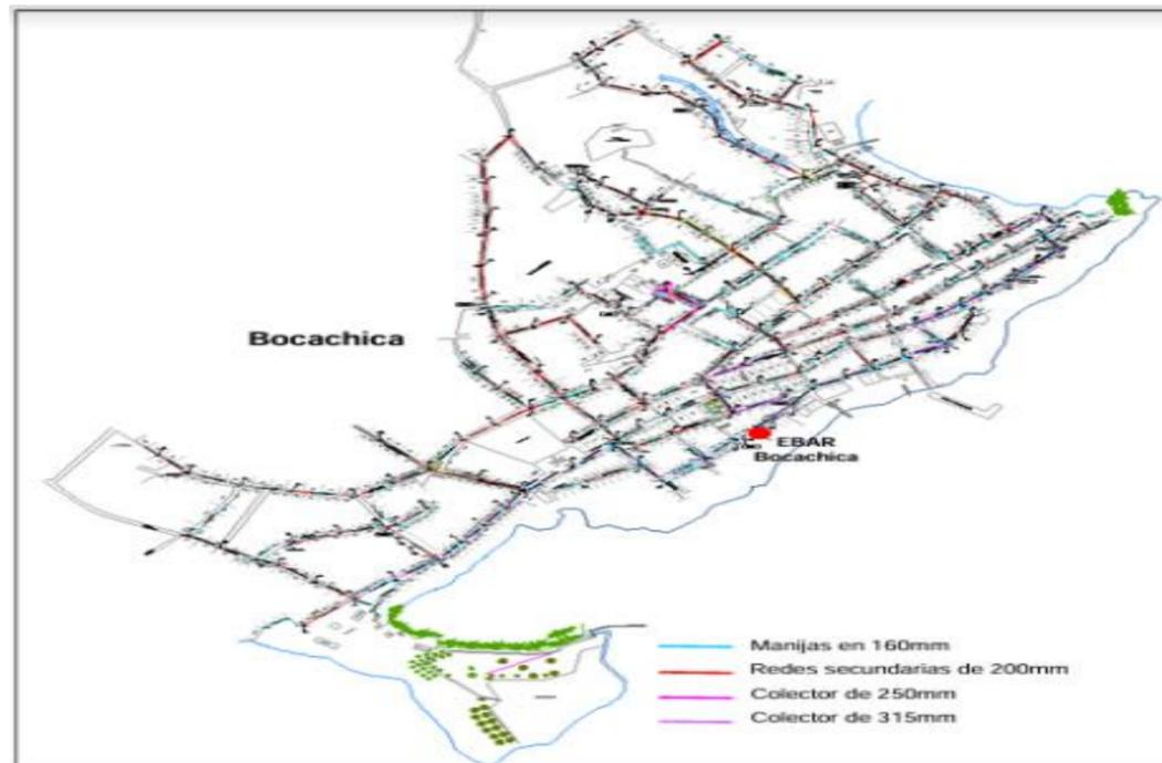
Ilustración 4. Esquema redes de alcantarillado Bocachica
