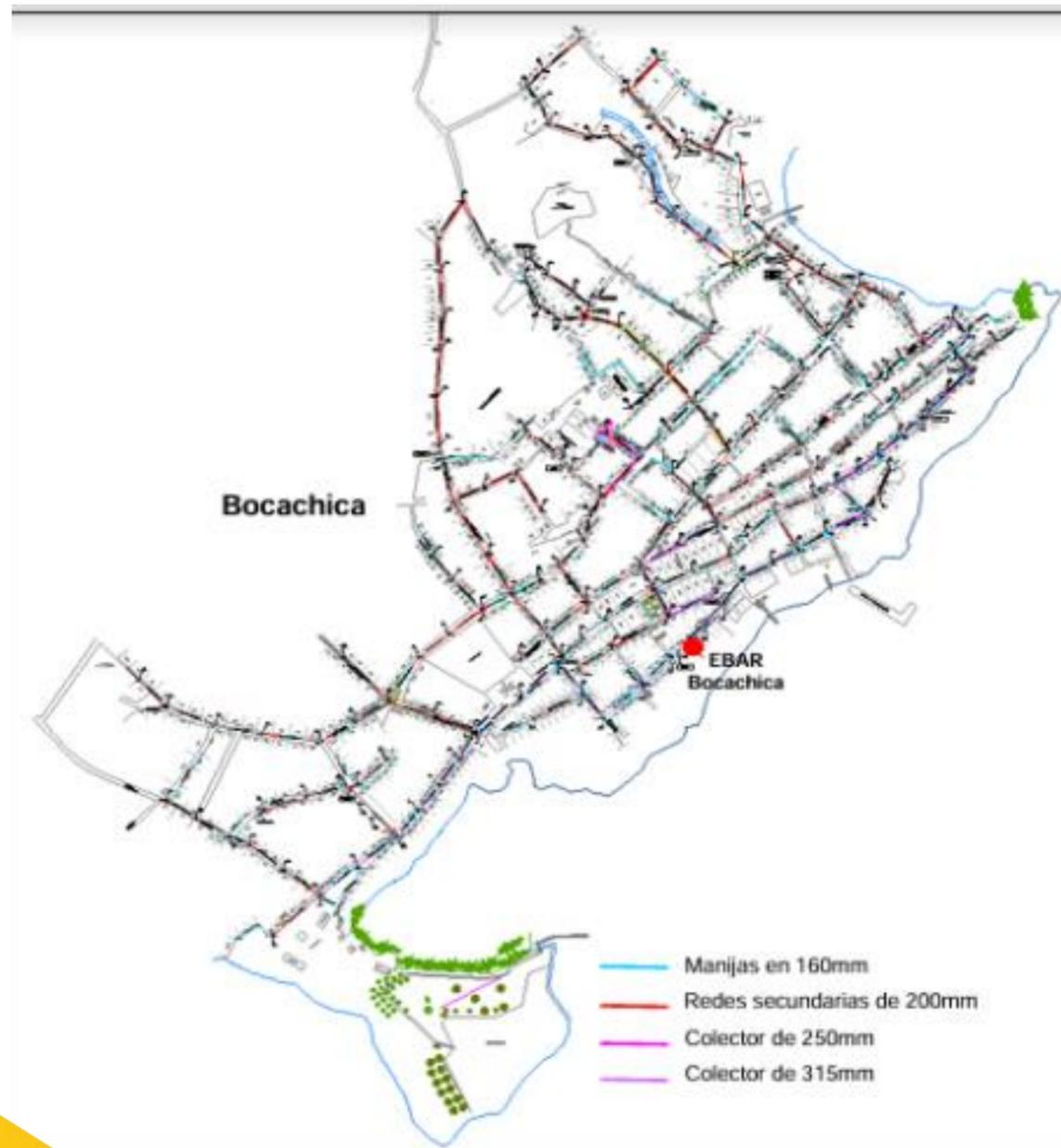
Ilustración 4. Esquema redes de alcantarillado Bocachica
